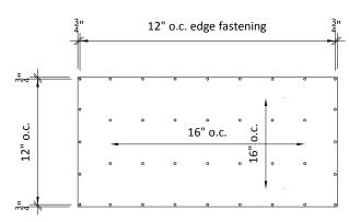
Fig. 7 - Fastener Spacing Diagram
