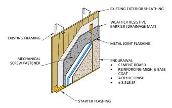
Fig. 6.4 – Light Gauge Metal Stud Wall
